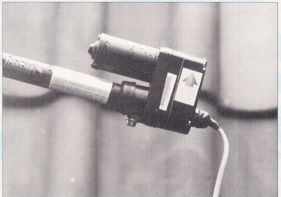
Foto 1: Monteer de actuator goed (let op het ontwater-gaatje!).
